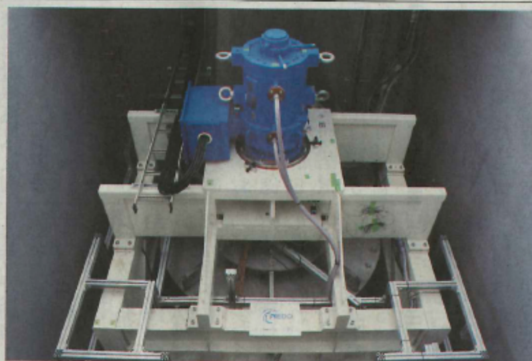
米倉山の超電導フライホイール実証機
